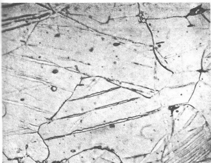
ציור 2 - תצלום בהגדלה \times 800 של פלדה דלת-פחמן לאחר פיצוץ. ניתן להבחין בקלות בתיאומים המכניים (פסי-ניומן).
