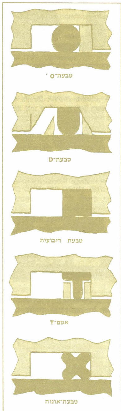
ציור 7 — צורות אופייניות של אטמי-מעכה.
