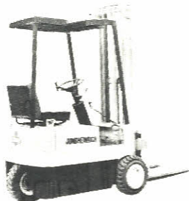
מלגזות הרמה חשמליות EFG-300 לשימוש במחסנים ובחצרות כשר הרמה 1000 - 1500 ק"ג.
