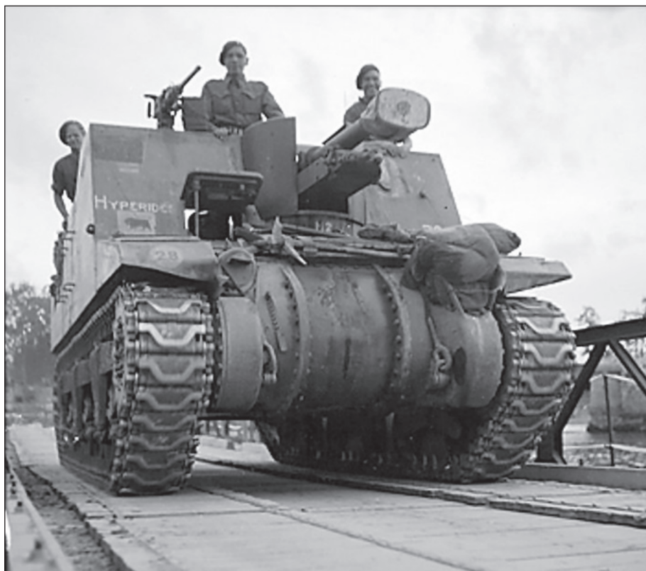
תותח מתנייע בריטי מדגם סֶקְסְטון – תותח 25 ליטראות מורכב על תובה של טנק שרמן
