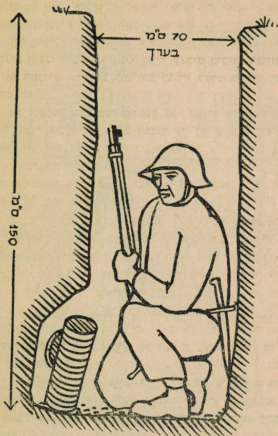
ציור מספר 50 — שוחת שריון רצוי לחזק את השוחה בקלונסאות ובדופן קלוע של ענפים.
