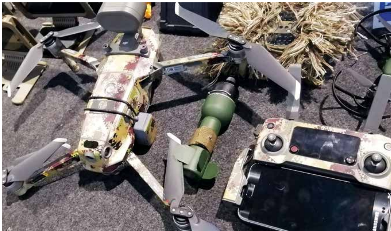
רחפן פשוט שהוסב לרחפן נושא חימוש (רימון). לשימוש ברחפן מטיל יתרונות בולטים, המפצים על חסרונות כמו טווח פעולה קצר ומשקל נשיאה מועט. צילום: ויקיפדיה
