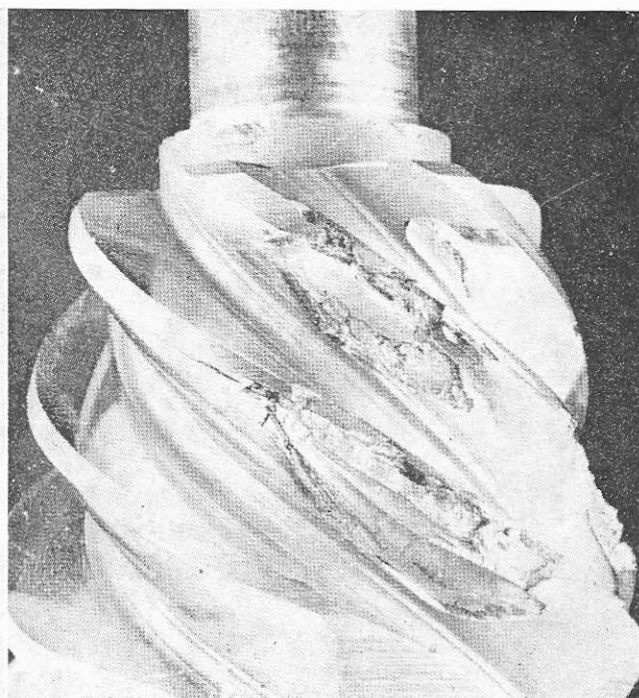
ציור 7: בשלב הראשון של התעיפות שיבוב, נראים סדקים ארכיים שהתפתחו על המשטח הפעיל של השן (שמאל). בשלב השני, הרס השיבוב לחלוטין את הגלגל עקב התפרקות רסיסים גדולים. הגלגל עשוי פלדה 4817 מצומנט.
