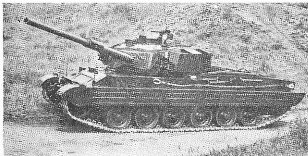
הטנק הבריטי "ויקרט" הוא בעל אותו מנוע וממסרה כמו של ה"ציפטיין". משקלו 14 טונה פחות משל ה"ציפטיין". בתמונה נראה מקלע הטיח שלו בן 12.7 מ"מ והמקלע המקביל בן 7.62 מ"מ.
