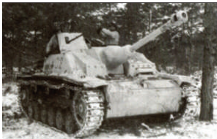
תותח־סער גרמני מדגם שְׂטוּרְמֶגְשׁוֹן 3 בעל תותח 75 מילימטרים ארוך־קנה
