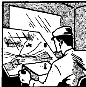
ע"י שימוש בלוח-עקיב נונה מפעיל-המטוס את המטוס מעל לשטח אותו יש לצלם, מורה על ביצוע הצילומים ומחזיר את המטוס למקומו.
