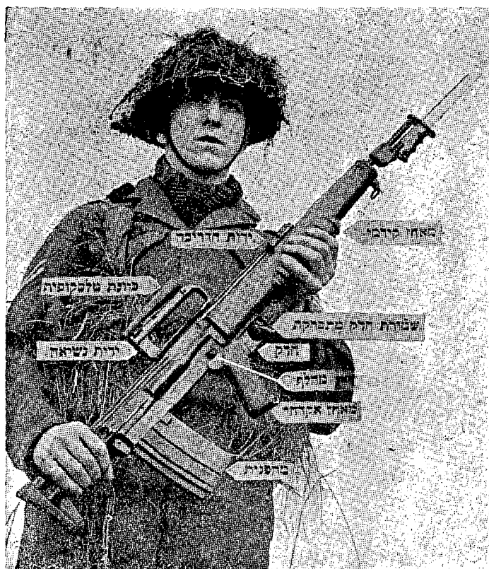
הרובה המטען כשכידונו מוצמד שיס-לב: לכונת הטלסקופית על ידית זנשיאה; למחסנית הגדולה; למחלק, המאפשר יריה אבטומטית ובודד
