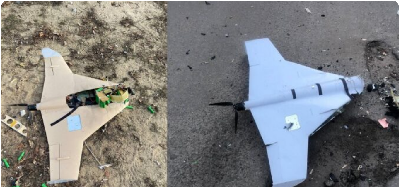
תחילת הלחימה; שני משוטטים רוסיים מדגם ZALA KYB שניסו לפגוע במטרות בעיר קייב (או בשוליה) אך כשלו בתקיפה ובפיצוץ. מאפייניהם: קצרי טווח, תצורת כנף דלתה, הנעה חשמלית ומכלולים מסחריים. מקור: טוויטר
